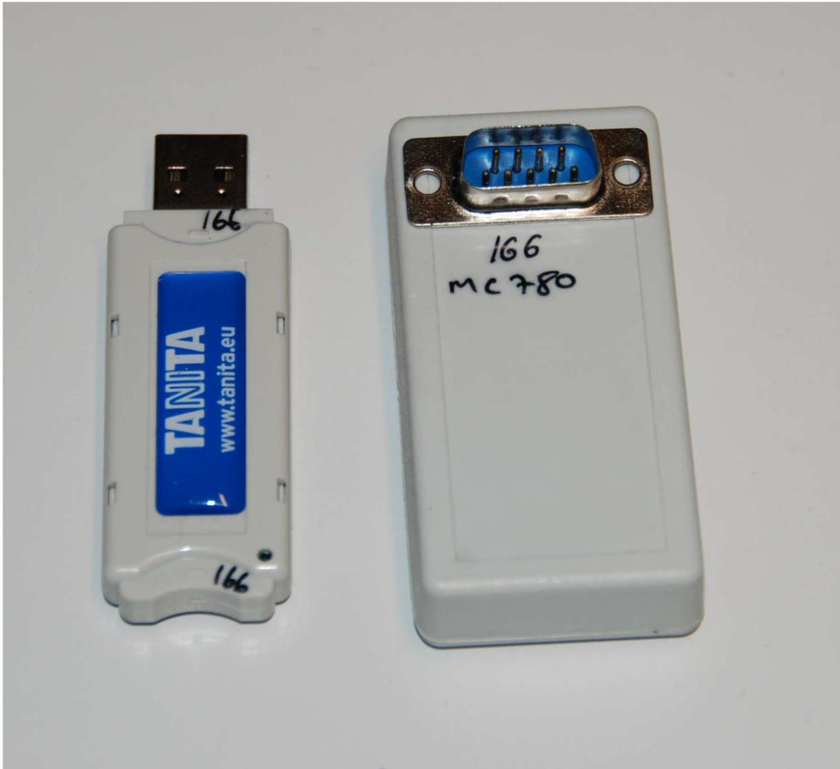
Das Bluetooth-Kit hat zwei Teile, ein Slave Modul (9-pin Stecker zum Senden der Daten) und einem Master Modul (USB-Empfänger für den PC)
